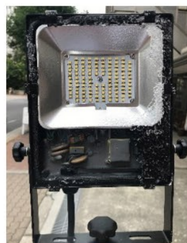
NLFL投光燈 燈具玻璃破碎情況
